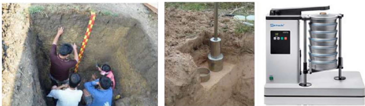
รูปที่ 2 การขุดหลุมดิน เพื่อเก็บตัวอย่างดิน แล้วนำมาวิเคราะห์หาปริมาณอนุภาคดินแต่ละขนาด
