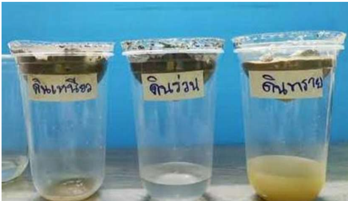
รูปที่ 6 การทดลองการอุ้มน้ำและระบายน้ำของเนื้อดินชนิดต่าง ๆ
