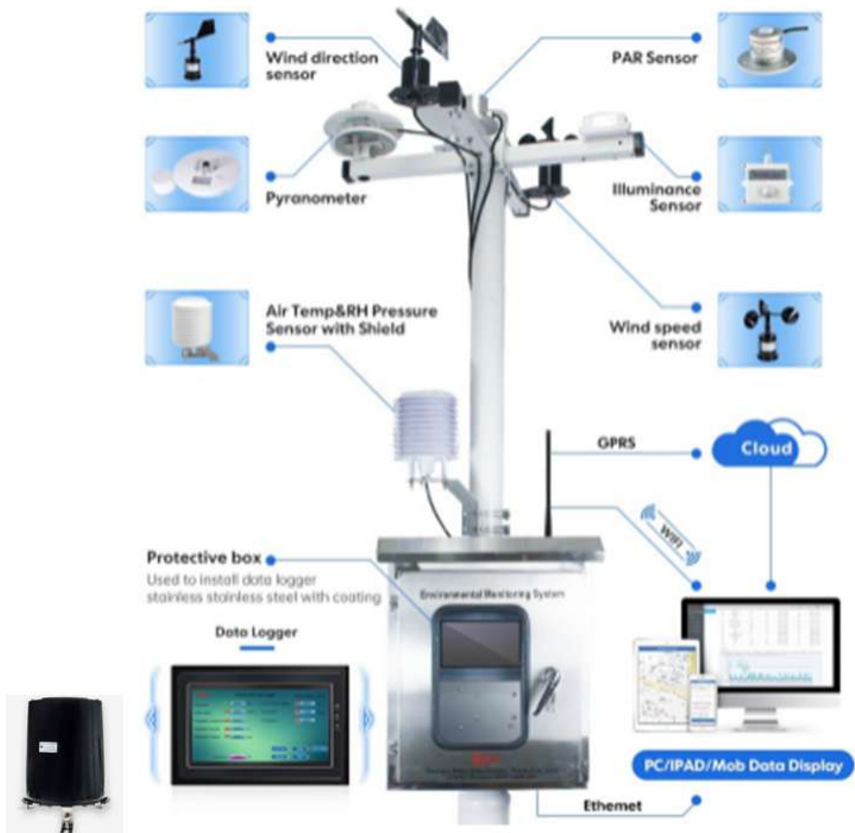
รูปที่ 5.23 เครื่องมือตรวจอากาศแบบอัตโนมัติ
