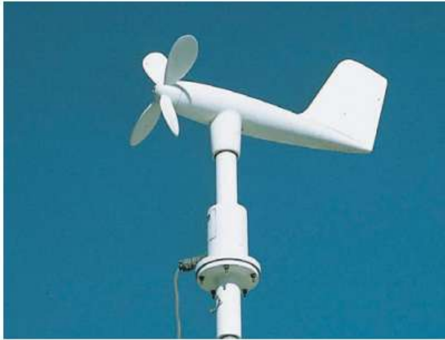
รูป 6.20 เครื่องวัดทิศทางลม (wind vane) และเครื่องวัดความเร็วลมแบบ Propellor
